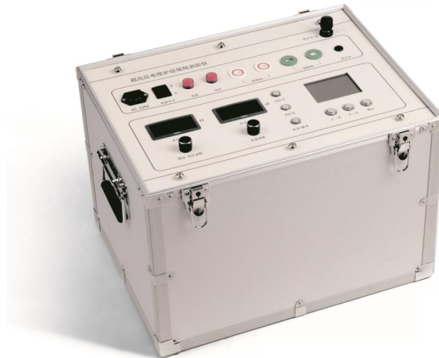
Figure1. FLC-900D Localizador de fallas en la cubierta del cable EHV
